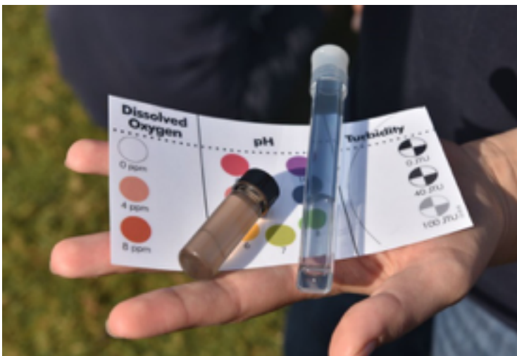
Χρωματικό διάγραμμα για τον προσδιορισμό των αποτελεσμάτων των δοκιμών
